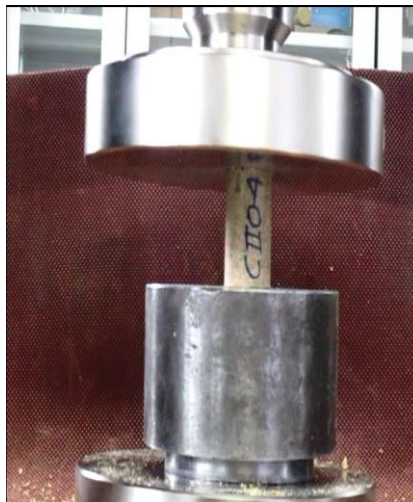
Figura 2.6: Montaje de ensayo de resistencia a compresión.
