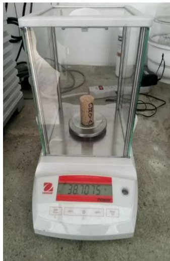
Figura 2.3: Báscula de precisión con resolución 0,0001g marca Ohaus PA224 - Pioneer Analytical Balance, 220 g x 0,1 mg.
