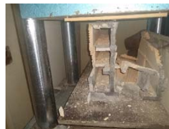
Imagen 9. Ensayo compresión unidades de mampostería – espécimen 4. Fuente (Elaboración propia).
