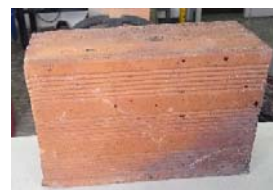
Imagen 10. Ensayo compresión unidades de mampostería – espécimen 5. Fuente (Elaboración propia).
