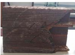
Imagen 10. Ensayo compresión unidades de mampostería – espécimen 5. Fuente (Elaboración propia).
