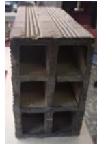
Imagen 8. Ensayo compresión unidades de mampostería – espécimen 2. Fuente (Elaboración propia).
