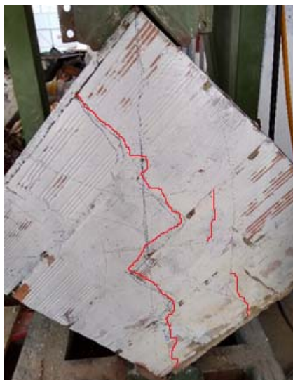
Figura 1-14 Falla debido a tensión diagonal. Fuente (Propia)
