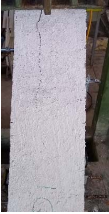
Imagen 23 Ensayo tensión diagonal 3. Fuente (Propia)
