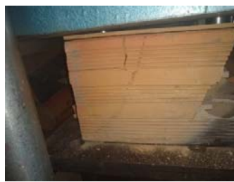
Imagen 9. Ensayo compresión unidades de mampostería – espécimen 4. Fuente (Elaboración propia).
