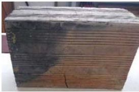
Imagen 8. Ensayo compresión unidades de mampostería – espécimen 2. Fuente (Elaboración propia).
