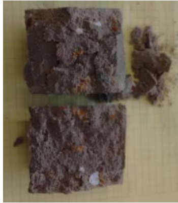
Imagen 14 Registro fotográfico, ensayo de cubo mezcla 1:2 sometido a compresión. Fuente (Elaboración propia).
