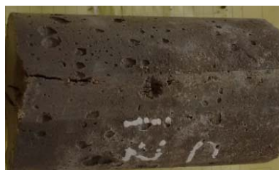
Imagen 15 Registro fotográfico, ensayo de cilindro de mortero sometido a tensión indirecta. Fuente (Elaboración propia).
