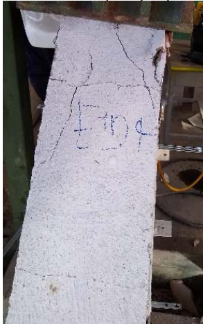
Imagen 25 Ensayo tensión diagonal 5. Fuente (Propia)
