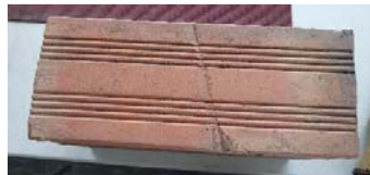
Imagen 10. Ensayo compresión unidades de mampostería – espécimen 5. Fuente (Elaboración propia).
