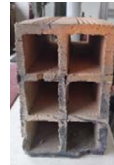
Imagen 10. Ensayo compresión unidades de mampostería – espécimen 5. Fuente (Elaboración propia).
