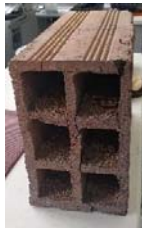
Imagen 10. Ensayo compresión unidades de mampostería – espécimen 5. Fuente (Elaboración propia).
