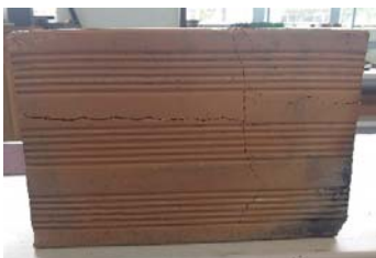
Imagen 10. Ensayo compresión unidades de mampostería – espécimen 5. Fuente (Elaboración propia).
