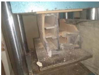
Imagen 9. Ensayo compresión unidades de mampostería – espécimen 4. Fuente (Elaboración propia).
