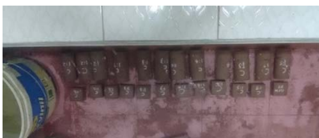
Imagen 2 Registro fotográfico del curado de los especímenes de pañete. Fuente (Elaboración propia).
