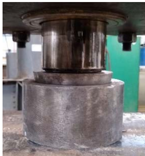
Imagen 6. Rótula de carga, ensayo de compresión. Fuente (Elaboración propia).
