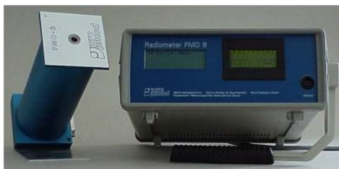
Figura 4: Pirheliómetro de cavidad absoluta, serie PMO-6.
