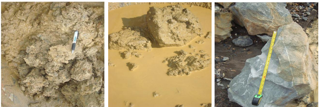
Fotografías 1 a 3. Aspecto de la matriz y bloques del depósito coluvial. Marzo de 2010.
