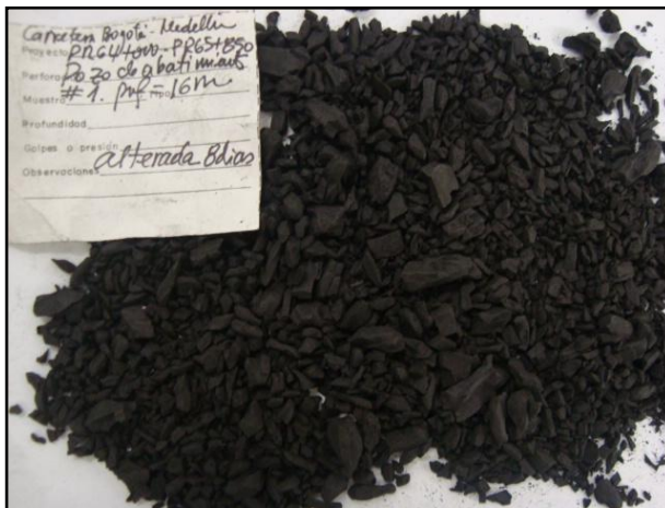
Fotografías 21 y 22: Fragmentos en forma de astilla de lodolita, ocasionados por efectos de meteorización durante 8 días. Muestra 11.
