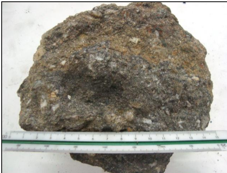
Fotografía 24 Clasto de litoarenita conglomerática del depósito que se halla sobre las laderas coluviales. Nótese que se observan clastos grandes (blancos y anaranjados), generalmente de cuarzo y chert, correspondientes a gránulos y guijos que le dan el carácter de conglomerática a esta arenisca. Adicionalmente, en la parte superior de la fotografía, la muestra presenta evidencias de meteorización: hidróxidos de hierro en su superficie (ocre). Muestra 13.
