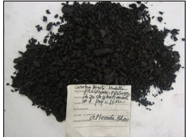
Fotografías 21 y 22: Fragmentos en forma de astilla de lodolita, ocasionados por efectos de meteorización durante 8 días. Muestra 11.
