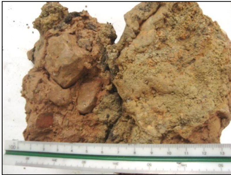
Fotografía 25: Matriz arcillosa del depósito que se encuentra sobre las laderas que presentan fenómenos de remoción en masa. Incluidos se hallan guijos subredondeados. Muestra 14.
