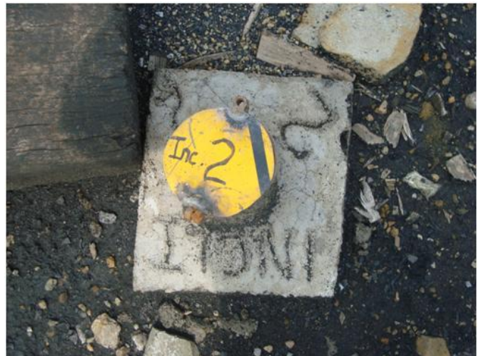
Fotografía 27. Inclinómetros para medir tasas de deformación y registrar profundidad de superficies de falla del deslizamiento (Foto:2010).
