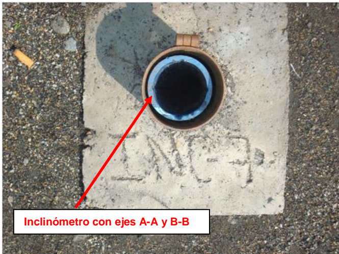
Fotografía 27. Inclinómetros para medir tasas de deformación y registrar profundidad de superficies de falla del deslizamiento (Foto:2010).
