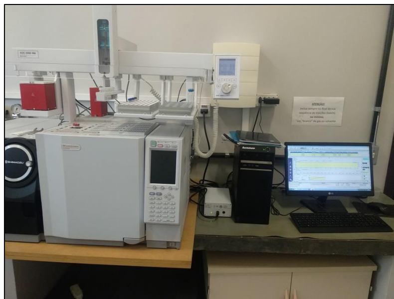
Figura 2.9 Cromatógrafo de gases acoplado a espectrometría de masas utilizado para los análisis de HAPs
