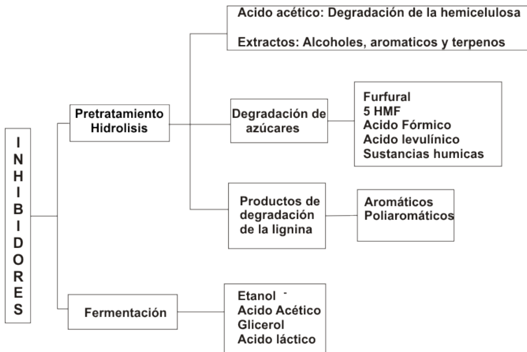
Figura 1-3. Inhibidores formados en las etapas de pretratamiento, hidrólisis y fermentación.
