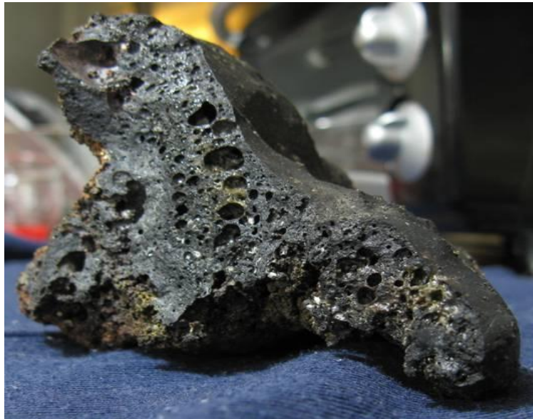
Figura 12: Escoria formada en calderas de carbón.
