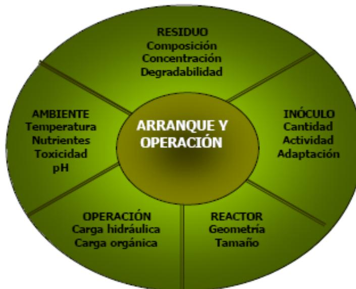
**Figura 2.3.** Factores que afectan el arranque y operación de un reactor anaerobio.
