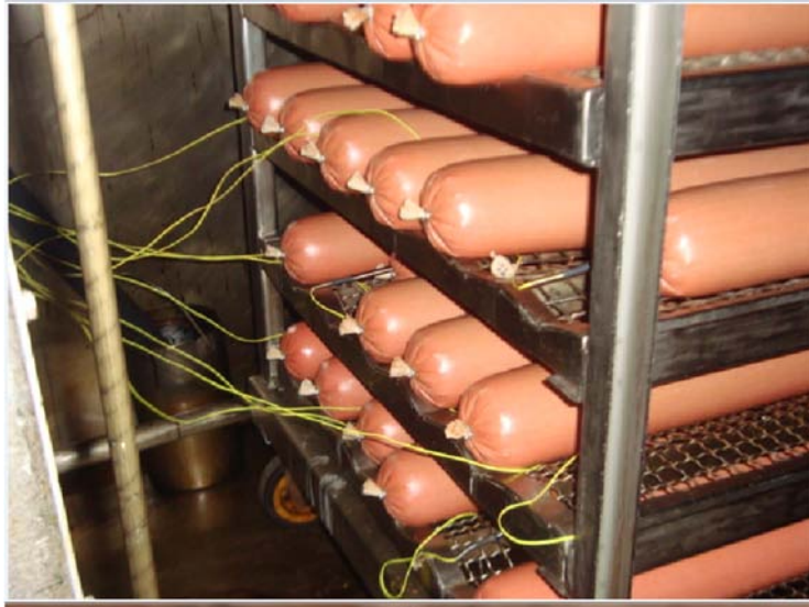
Figura 3-3: Carro de mortadela con sensores para la medición de temperatura.
