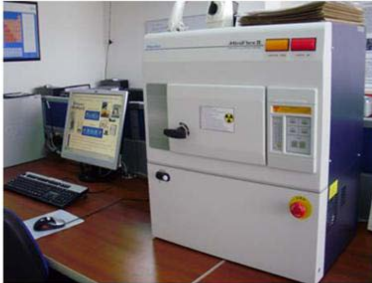
FIGURA 2-1. Equipo de difracción de rayos X RIGAKU Miniflex II.
