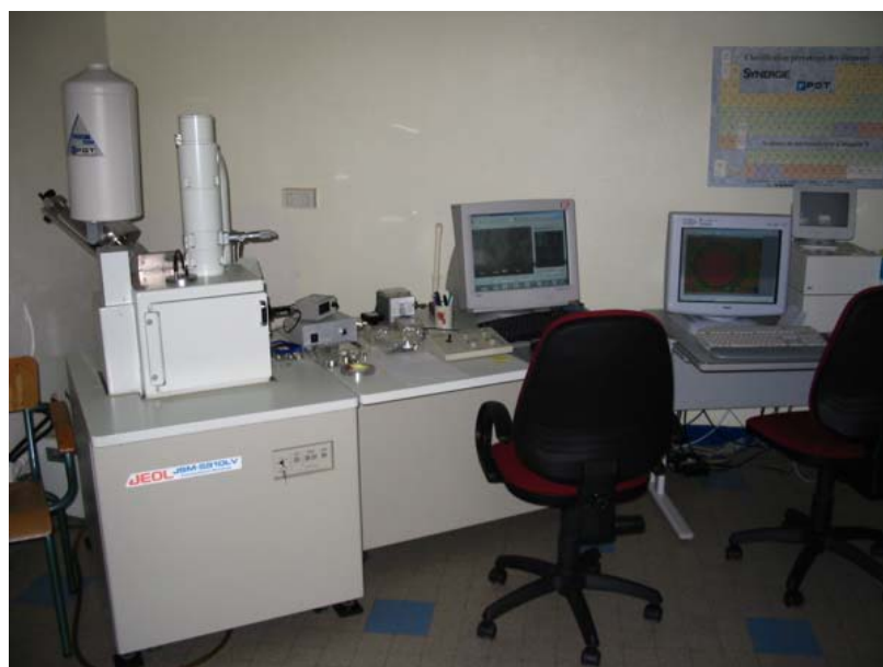
FIGURA 2-2. Microscopio electrónico Jeol JSM 5910LV.
