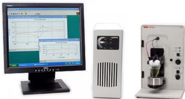
FIGURA 2-4. Equipo BASI Epsilon para pruebas Electroquímicas: voltametría cíclica.
