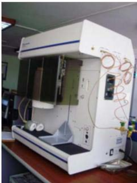
FIGURA 2-3. Analizador de área superficial marca Micromeritics modelo ASAP 2020.
