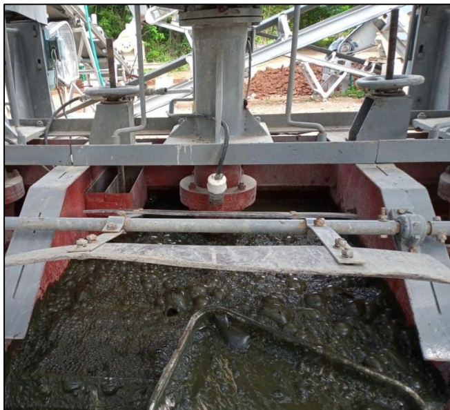
Imagen 6. Espuma producto del nuevo circuito de flotación.
