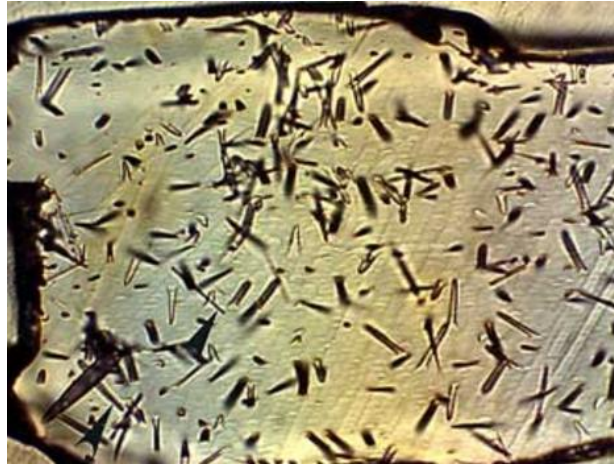
Figura 3.4 Pistas de fisión observadas en Zr con un microscopio electrónico.
