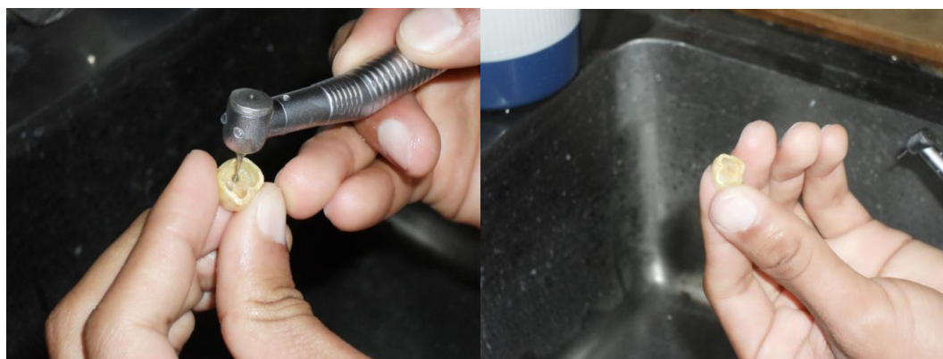
Figura 4.5. Remoción de la dentina del diente usando una fresa odontológica. La remoción se realizó hasta obtener un delgado cascarón de esmalte dental.
