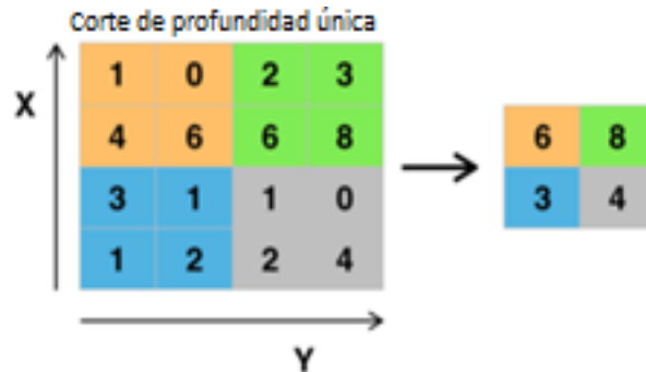
Figura 2-4: La capa de agrupación, simplifica la información reduciendo la resolución espacial de las características extraídas. Tomada de Iaar, (2020).
