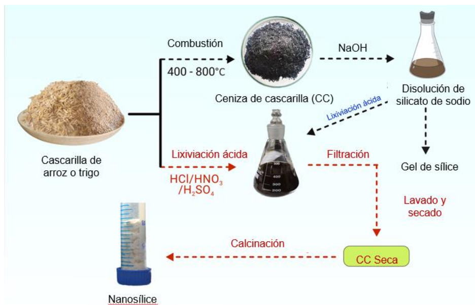
Figura 13. Síntesis de nanosílice a partir de biomasa residual. Tomado de Sarkar et al. 2021 [107].
