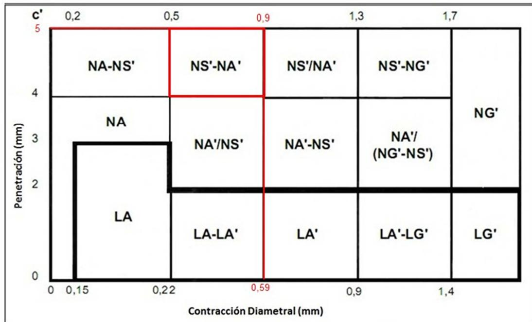
Figura 43. Clasificación MCT de la Muestra del km 49+200
