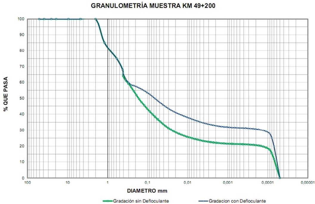
La fracción fina mostró proporciones mayores al usar defloculante que sin usar defloculante, esta diferencia muestra que existe agregación de las partículas finas.
