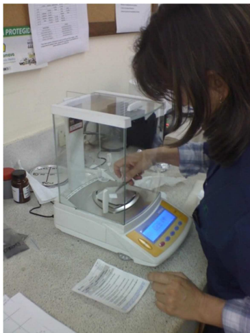
Foto 18. Etapas de pesado y secado de los papeles filtro en el laboratorio de carbones de la Universidad Nacional de Colombia sede Medellín
