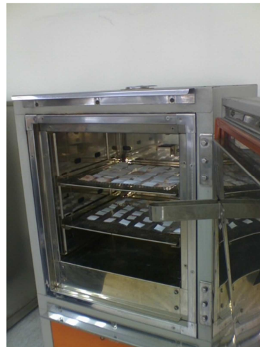
Foto 18. Etapas de pesado y secado de los papeles filtro en el laboratorio de carbones de la Universidad Nacional de Colombia sede Medellín
