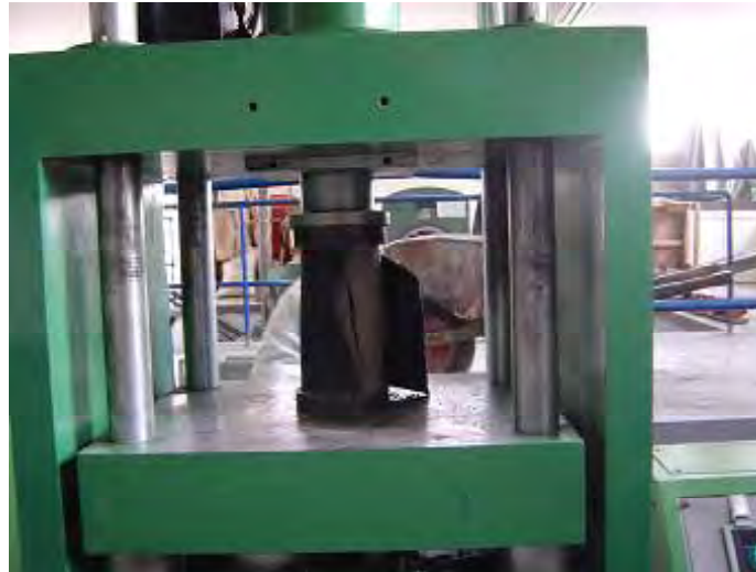
ENSAYO DE COMPRESIÓN DE CONCRETO
