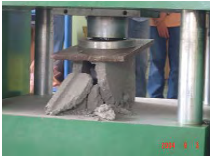
ENSAYO DE COMPRESIÓN EN BLOQUES DE MORTERO
