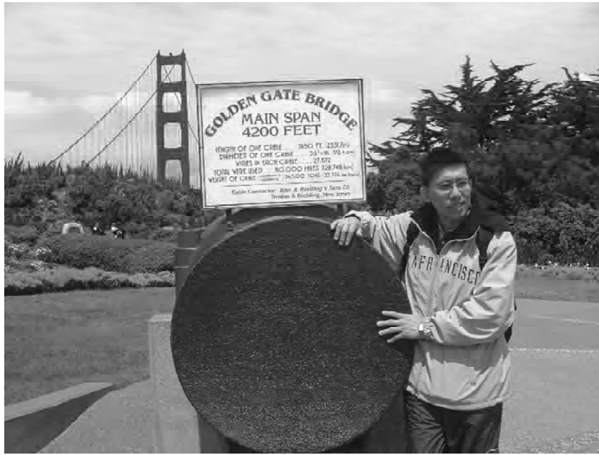
SECCIÓN TRANSVERSAL DE UNO DE LOS CABLES PRINCIPALES DEL PUENTE GOLDEN GATE EN SAN FRANCISCO. NÓTESE EL GRAN DIÁMETRO (92.4CM) DE UNO DE LOS CABLES PRINCIPALES CON LO CUAL SE GARANTIZA UN ÁREA SUFICIENTEMENTE GRANDE PARA DISMINUIR EL ESFUERZO ACTUANTE Y AUMENTAR LA SEGURIDAD DEL PUENTE.
