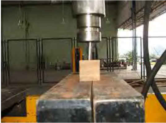
ENSAYO DE APLASTAMIENTO EN MADERA (Diseño del profesor José Christian Chanchí, Universidad Nacional de Colombia, Sede Manizales)
