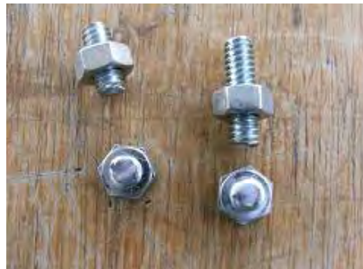
ENSAYO DE CORTE DE TORNILLOS (Diseño del profesor José Christian Chanchí, Universidad Nacional de Colombia, Sede Manizales)
