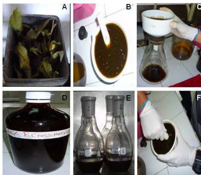
Figura 2. Obtención de extractos acuosos. A. Molinaje hojas; B. Mezcla de Material con etanol (80:20); C. Filtrado; D. Empaque; E. Determinación sólidos (estufa/105 °C); F. Solución madre
