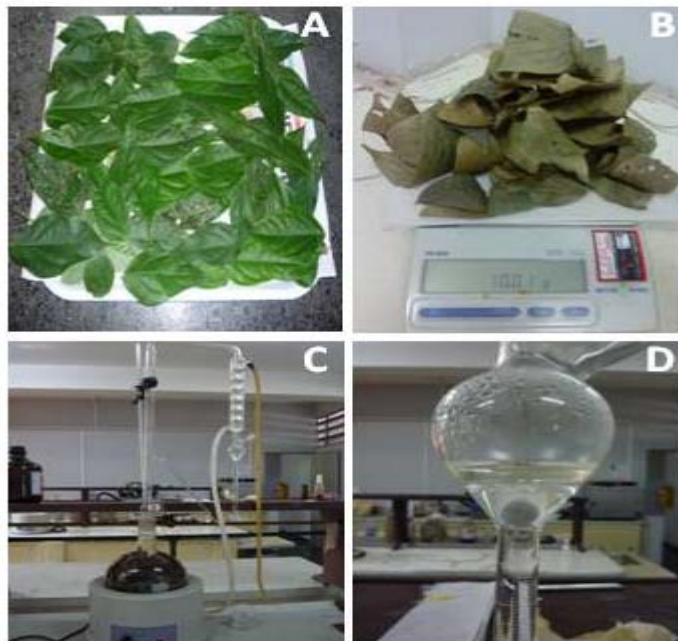
Figura 3. Extracción de aceite esencial por arrastre de vapor. A. Proceso de secado; B. Peso de hojas; C. Extracción con arrastre de vapor (equipo clevenger); D. Aceite esencial (fase acuosa)
