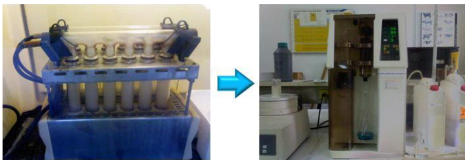
Figura 12. Proceso para realizar análisis de proteína por el método Kjeldhal.
