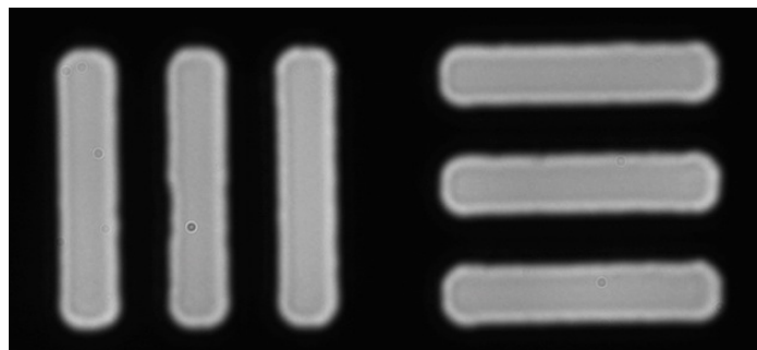
Figura 6.7. Elemento 6 del grupo +7 de un target de resolución USAF 1951 negativo, visto en el microscopio Nikon Eclipse Ti-U con una magnificación de 1500x.
